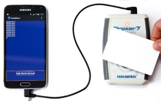
USB soros port / billentyűzet emuláció, kártyaolvasás okostelefonba speciális OTG kábelrel
